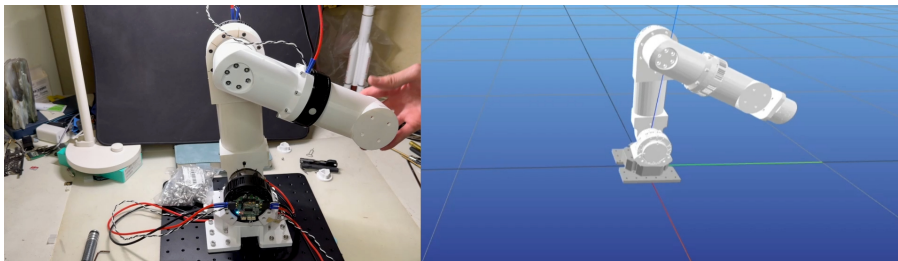
图 6-3 在 Pinocchio Meshcat 中验证姿态可视化正确性
