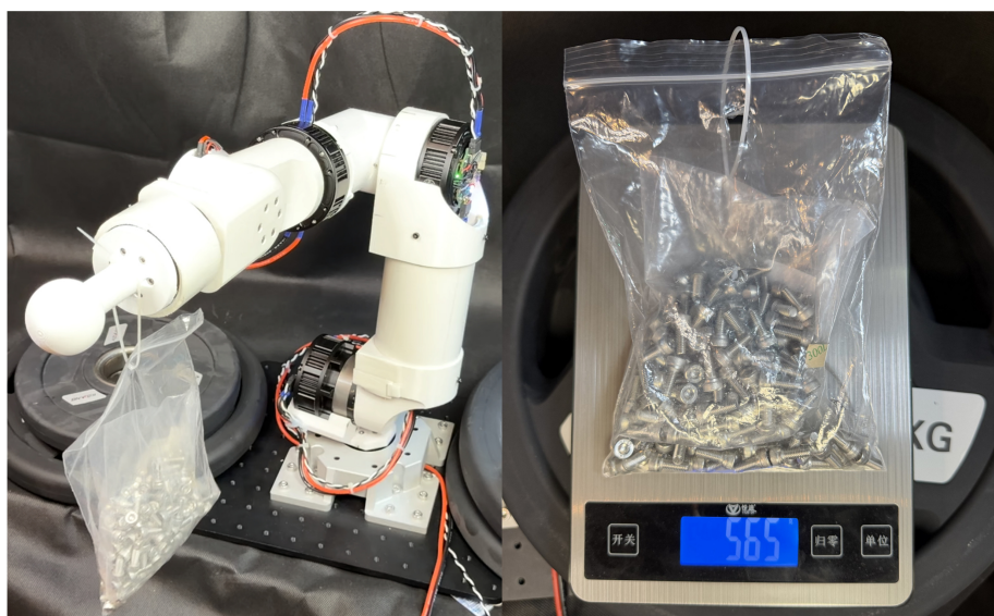
图 6-14 末端负载辨识实验一
