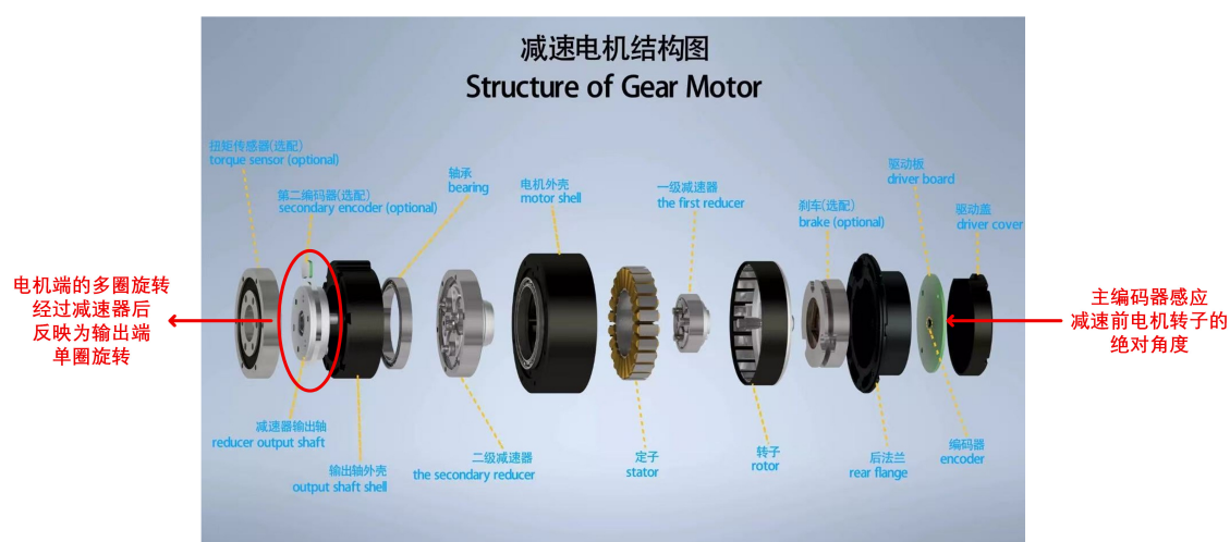
图 3-12 第二编码器示意图
